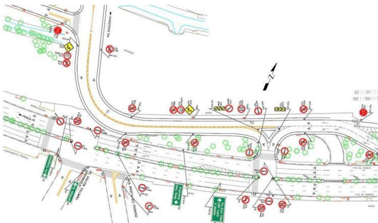
Figura 5.21 - Trecho do projeto de sinalização - Estação Engenheiro Goulart (CPTM, 2013)
