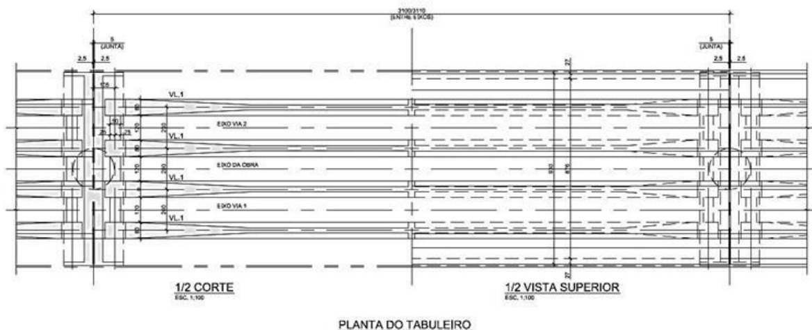
Figura 5.10 - Planta do Tabuleiro com Vão de 31 metros (CPTM, 2013)
